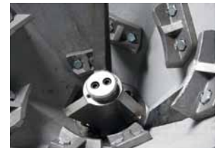
Brechraum mit Brecherwelle
