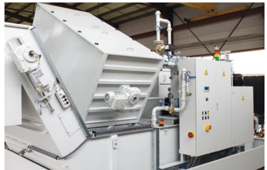
Siebtrommel auf kombinierter Anlage
