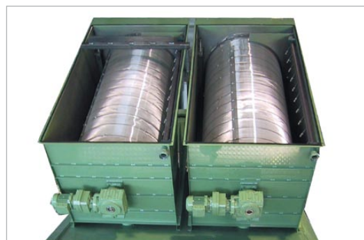
Tambour cribleur avec cribles en acier inoxydable et porte-vent
