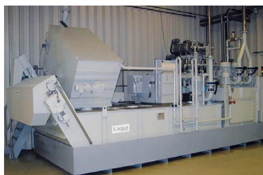
Filtre à tambour cribleur en tant que filtre grossier et préfiltre
